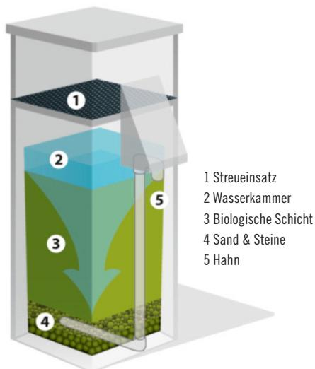
Modellabbildung eines Wasserfilters
